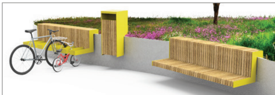
Suunnitteluesimerkki: Keltaiset teräsprofiilit ja pystysuorat puulamellit galvanoitulla reunaprofiililla.
