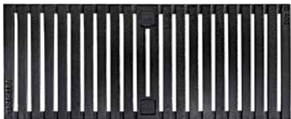
Uritettu ritilä, HEELGUARD , valurauta, mustamaalattu Kuormitusluokat: D400* Pituus: 50 cm, SW 6 mm
