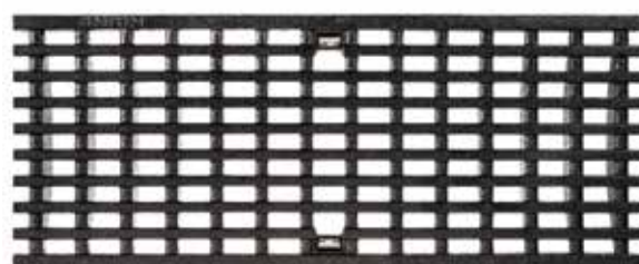
Pitkittäispalkkiritilä , valurauta, KTL-käsitelty Kuormitusluokat: D400*, E600*, Pituus: 50 cm, MW 25 x 11 mm
