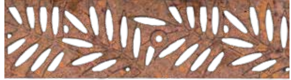
Designritilä, LEAF, valurauta, käsittelemätön Kuormitusluokat: C250, Pituus: 50 cm, SW 5 - 9 mm
