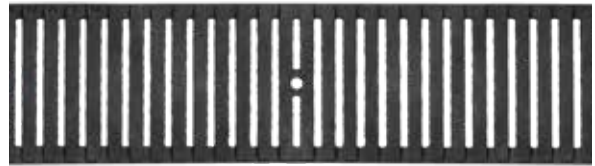
Uritettu ritilä, HEELGUARD, valurauta, mustamaalattu Kuormitusluokat: D400*, Pituus: 50 cm, SW 6 mm
