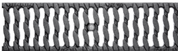
Uritettu ritilä, Oval Grip Design , valurauta, KTL-käsitelty Kuormitusluokat: C250, E600*, Pituus: 50 cm, SW 10 mm
